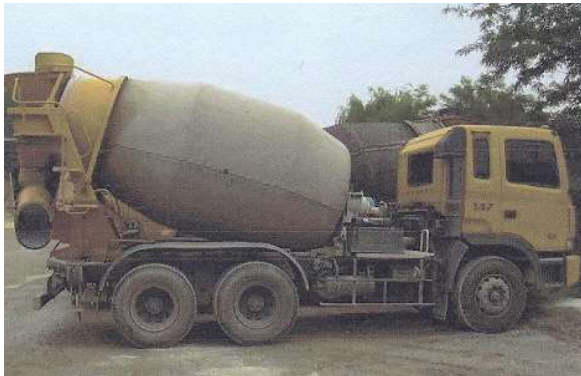
사진-6 운반차의 드럼표면 단열
